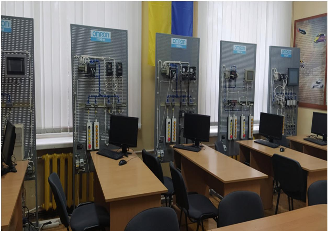
У експериментально-науково-дослідній лабораторії для роботи аспірантів, докторантів та здобувачів виконуються дослідження альтернативних джерел енергії на дослідницьких стендах з сонячними панелями та керуванням від контролера.
