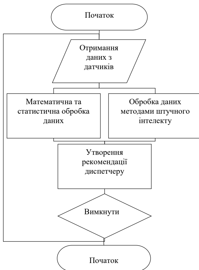
Рис. 4.12. Укрупнена блок-схема роботи програмно-апаратного комплексу
