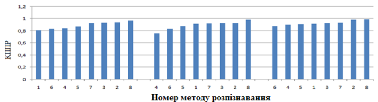
Рис. 4.18. Ненормований коефіцієнт ухвалення правильних рішень за станом ГТС різними методами з урахуванням зносу устаткування на реальних даних
